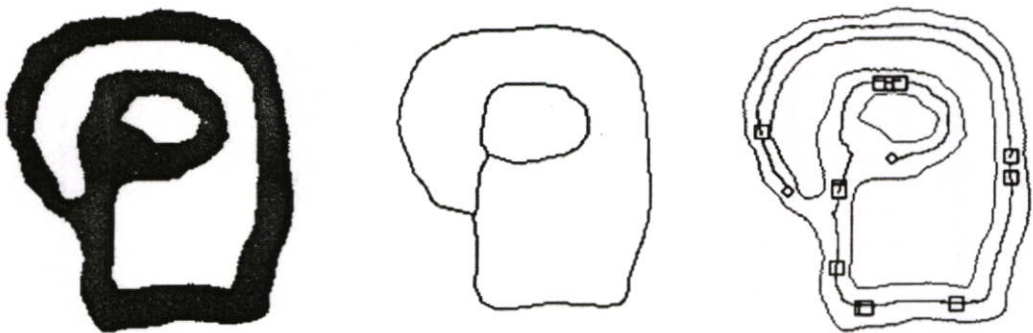
รูปที่ 4.49 การกำหนดจุดตั้งต้นให้กับตัวอักษรที่มีการเขียนเป็นวงปิด
