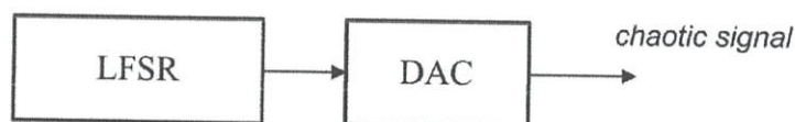
รูปที่ 3.11 ระบบการสร้างสัญญาณอลวนเชิงท่อนจากฟังก์ชัน saw tooth
