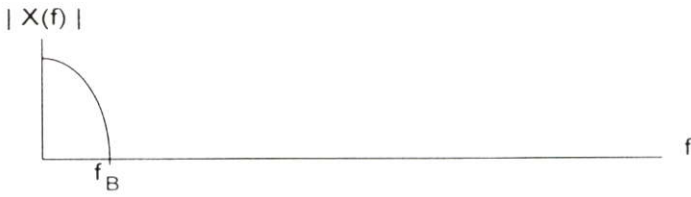
รูปที่ 2.2 ผลวิเคราะห์ทางความถี่ของสัญญาณอนาลอกที่มีความถี่สูงสุดเป็น f_B
