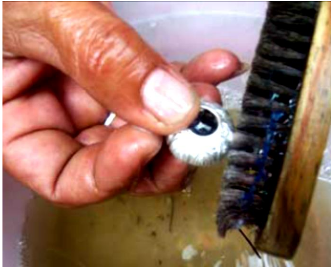
ภาพที่ 2.45 การขัดแปรงทองเหลือง
