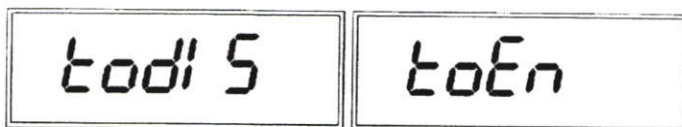
รูปที่ ค16 แสดงหน้าจอการเข้าสู่ระบบป้องกันการส่งสัญญาณ
