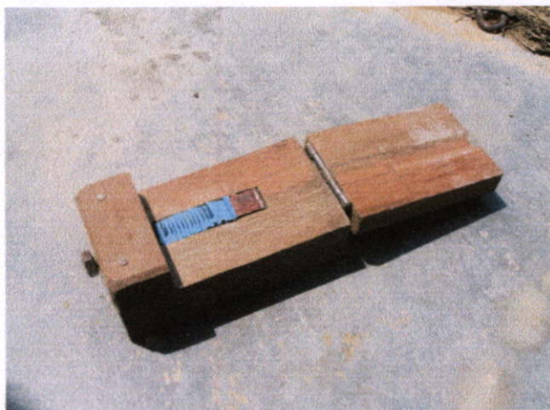
ภาพที่ 2.35 เครื่องเลื่อยใบลานที่กองอุตสาหกรรมในครอบครัวพัฒนาปรับปรุงขึ้น
