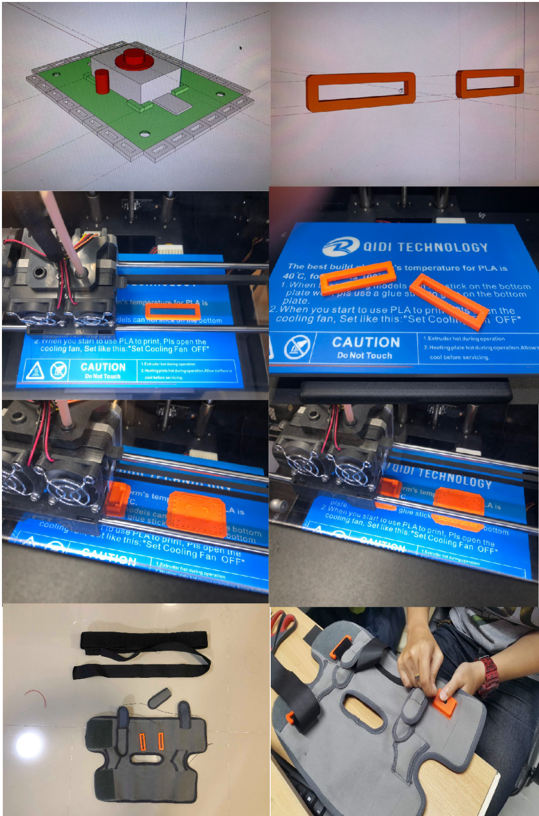
ภาพที่ 1 การผลิตชิ้นส่วนอุปกรณ์ด้วย 3D Printing และการเย็บชิ้นส่วนอุปกรณ์ ภาพโดย : จักรพรรดิ วิชาฤทธิ์
