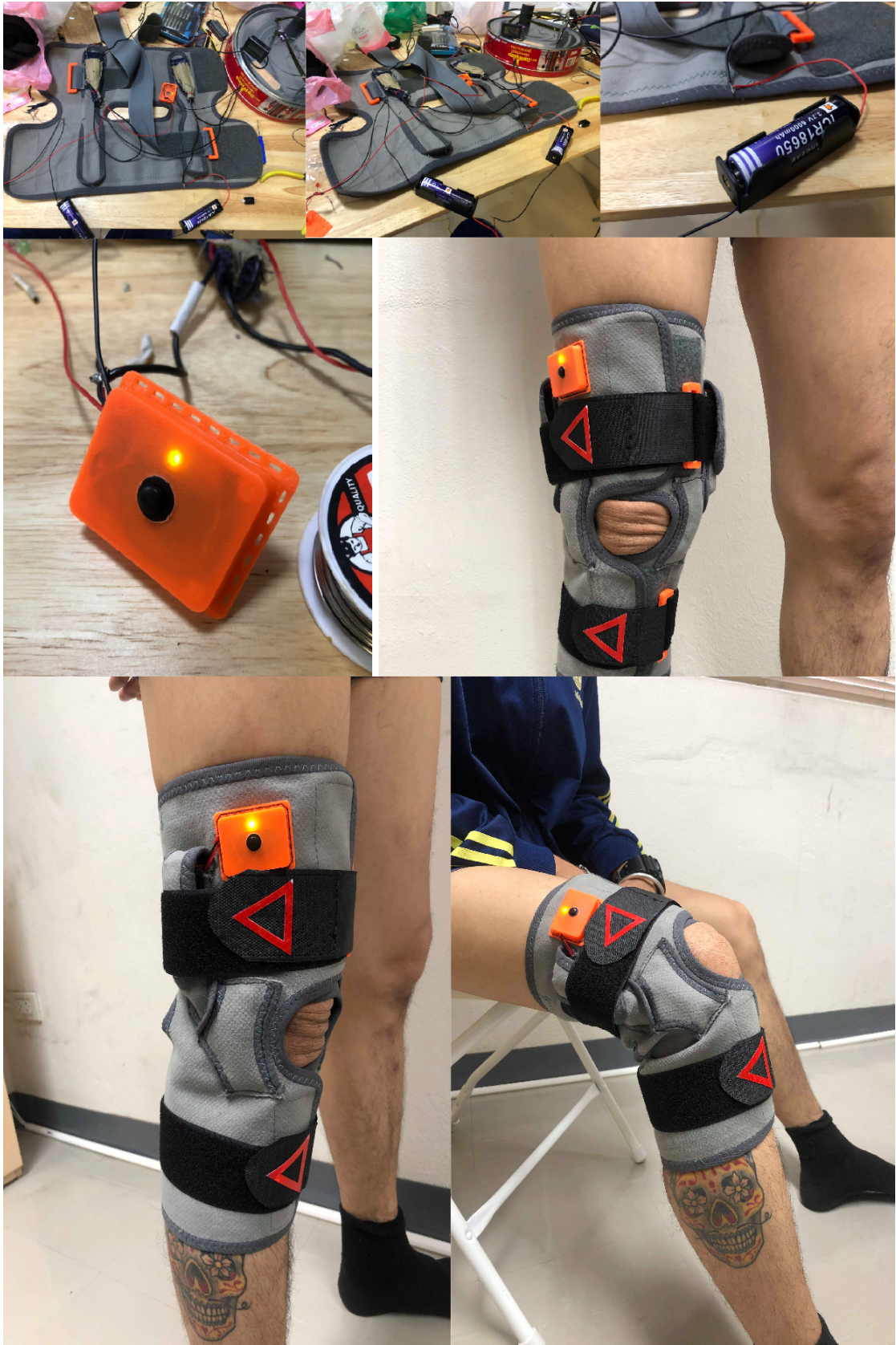
ภาพที่ 2 การประกอบชิ้นส่วนอุปกรณ์และติดตั้งระบบประคบร้อนไฟฟ้า ภาพโดย : จักรพรรดี วิชาฤทธิ์
