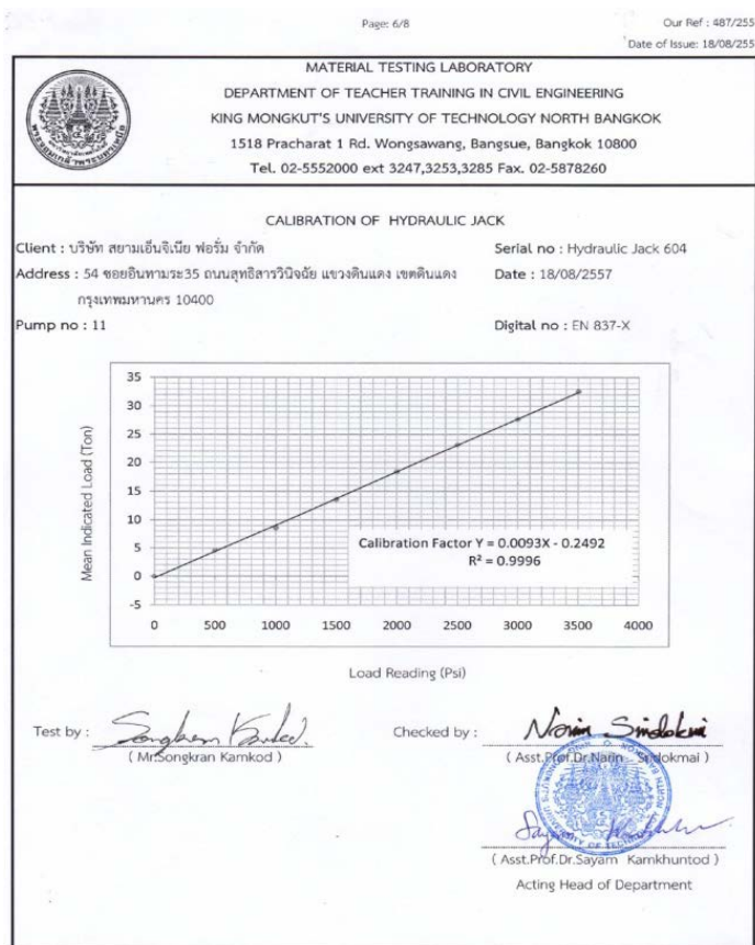
รูปที่ 2.14 เอกสาร CALIBRATION แม่แรงไฮดรอลิก เพื่อใช้ตรวจสอบกำลังรับน้ำหนัก
