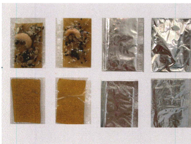
รูปที่ จ2 มะม่วงแผ่นที่บรรจุในซองพลาสติกใสและซองอลูมิเนียมลามิเนตพอยล์ในสภาวะบรรจุสุญญากาศและบรรยากาศ
