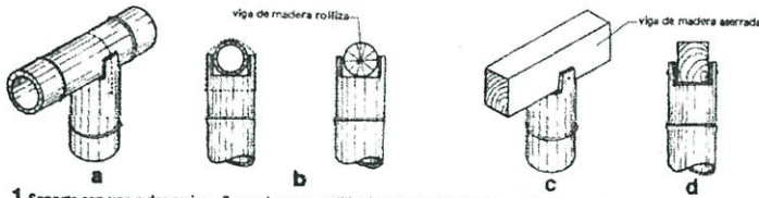
1 Soporte con una o dos orejas. Se emplea para recibir vigas de bambú, madera rolliza o aserrada
