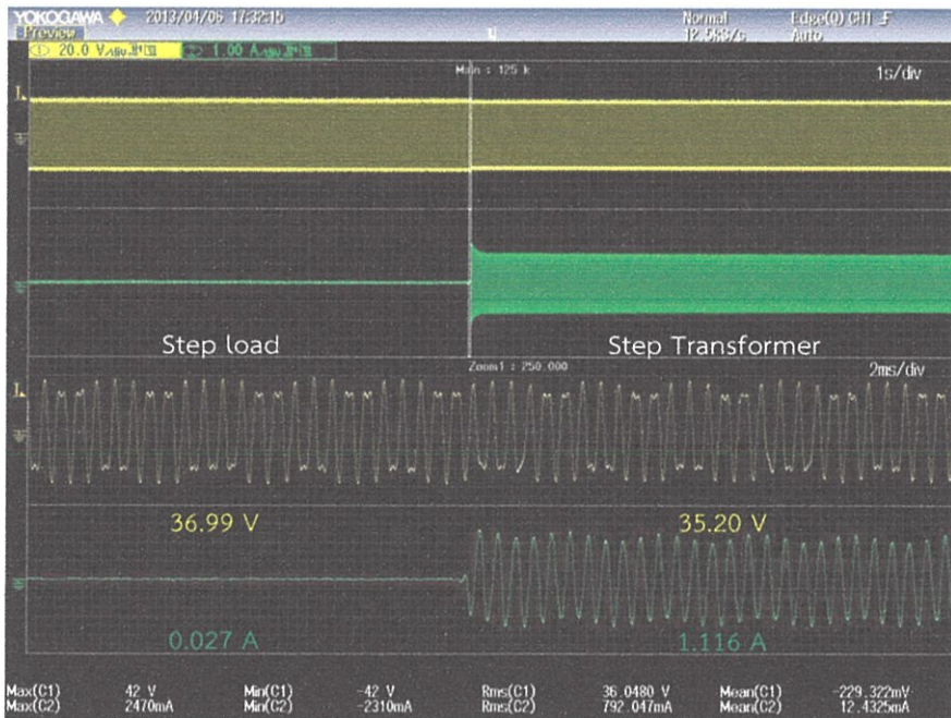
รูปที่ 6.44 แรงดันและกระแสไฟฟ้าที่หม้อแปลงความถี่สูง
