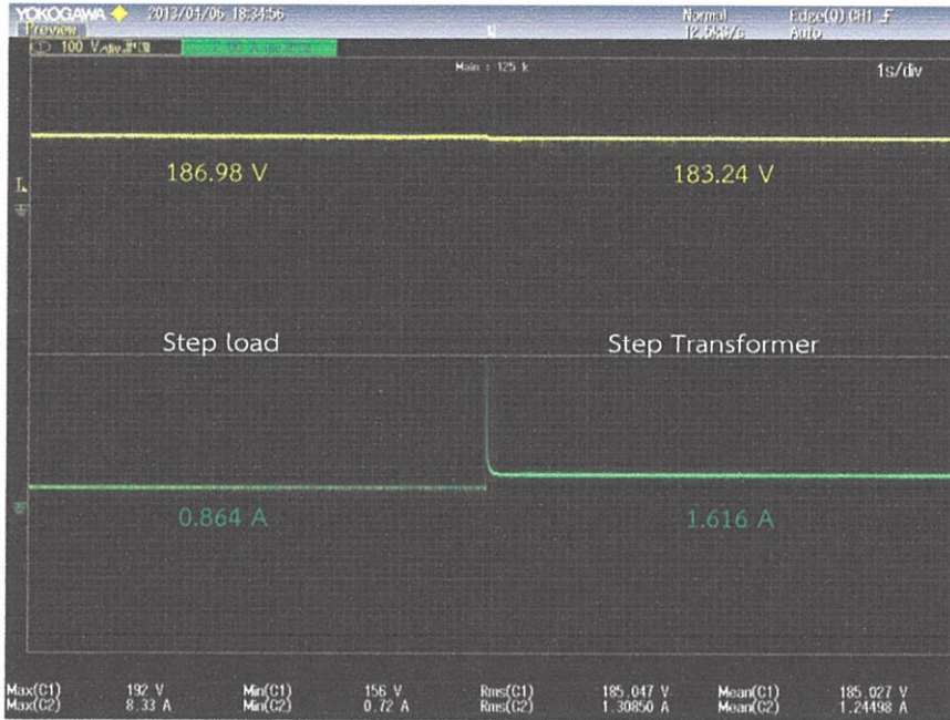
รูปที่ 6.59 แรงดันและกระแสไฟฟ้าที่ภาระไฟฟ้า
