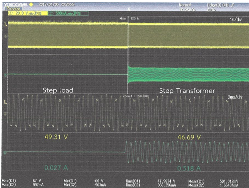
รูปที่ 6.62 แรงดันและกระแสไฟฟ้าที่หม้อแปลงความถี่สูง
