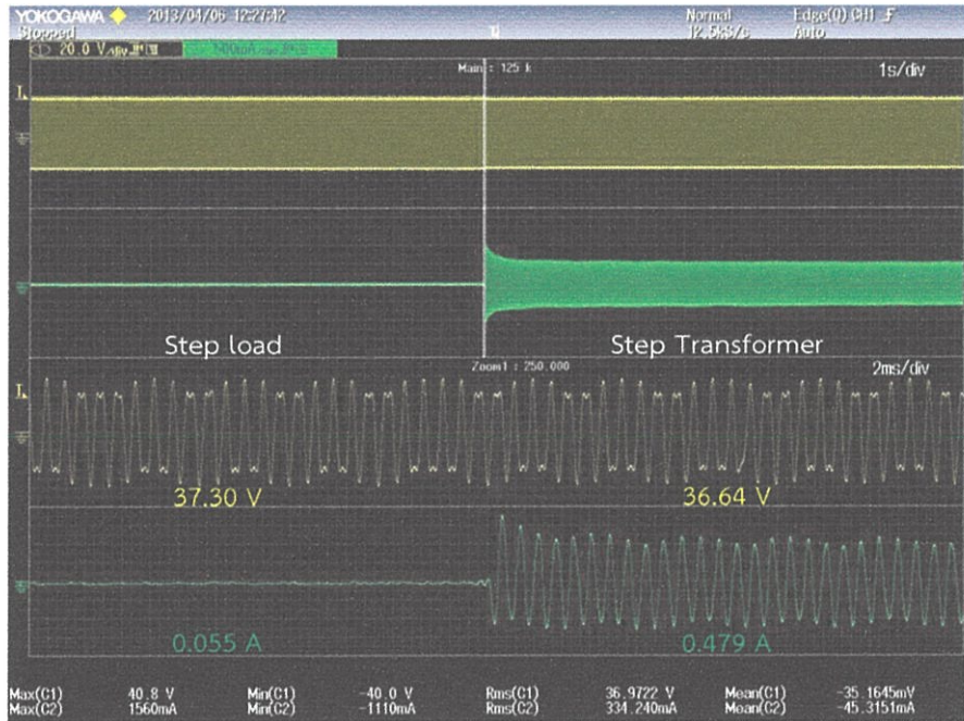
รูปที่ 6.21 แรงดันและกระแสไฟฟ้าที่หม้อแปลงความถี่สูง
