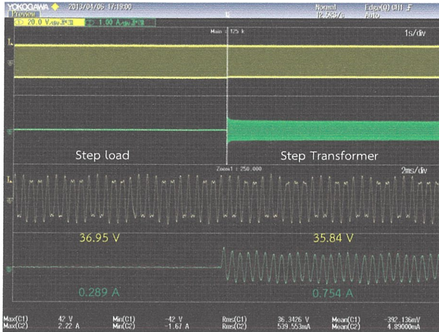
รูปที่ 6.40 แรงดันและกระแสไฟฟ้าที่หม้อแปลงความถี่สูง
