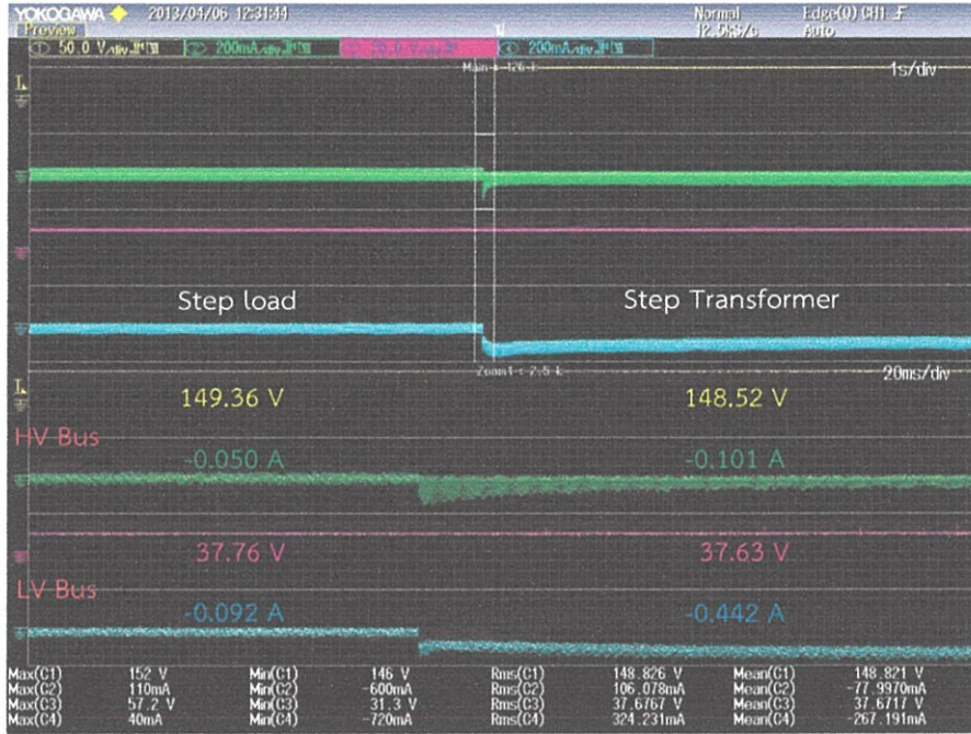
รูปที่ 6.20 แรงดันและกระแสไฟฟ้าที่ชุดวงจร M 2 C 3 ที่ 2
