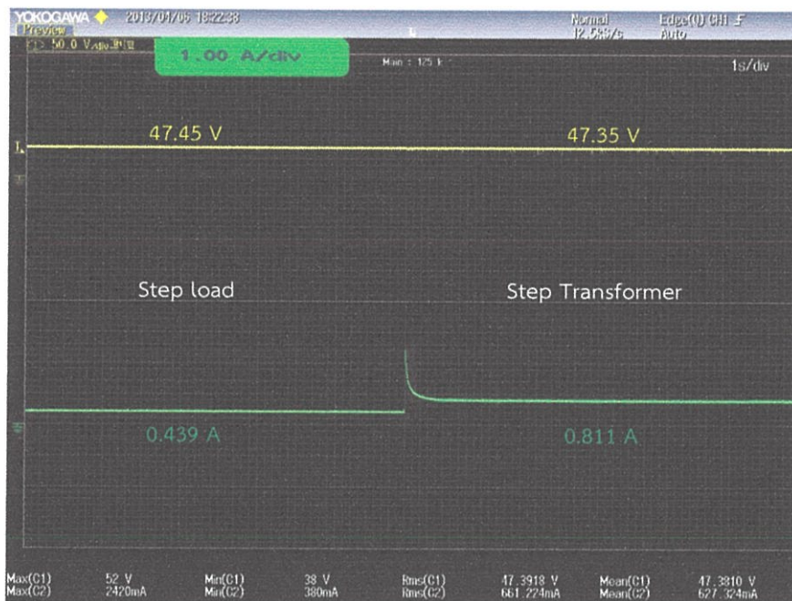
รูปที่ 6.68 แรงดันและกระแสไฟฟ้าที่ภาระไฟฟ้า
