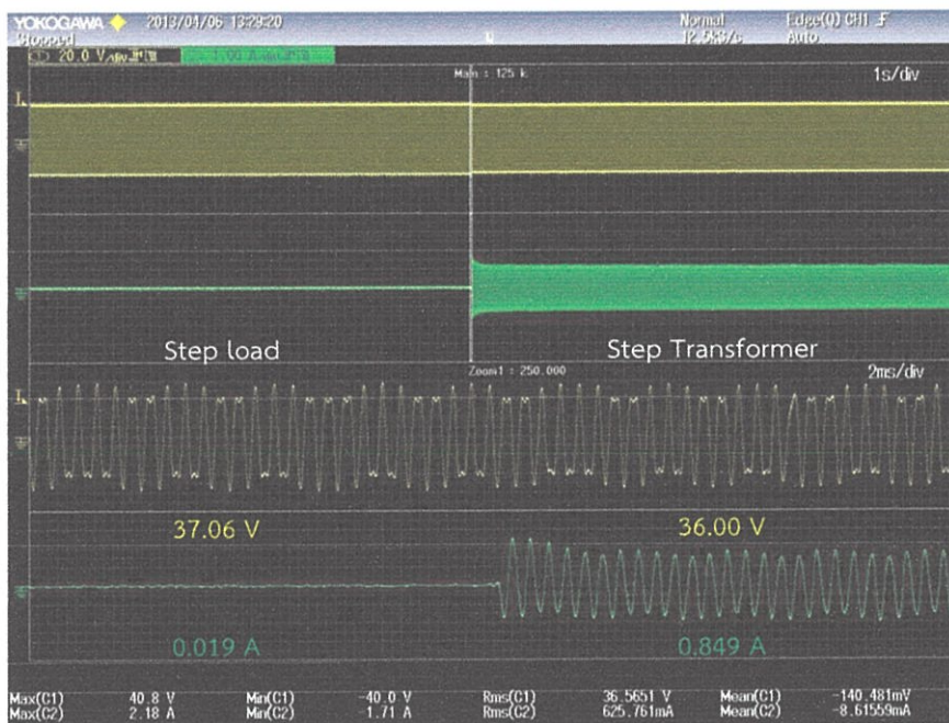
รูปที่ 6.8 แรงดันและกระแสไฟฟ้าที่หม้อแปลงความถี่สูง
