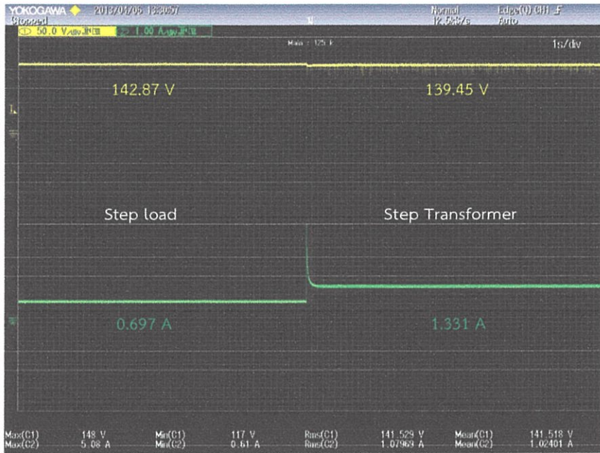
รูปที่ 6.5 แรงดันและกระแสไฟฟ้าที่ภาระไฟฟ้า
