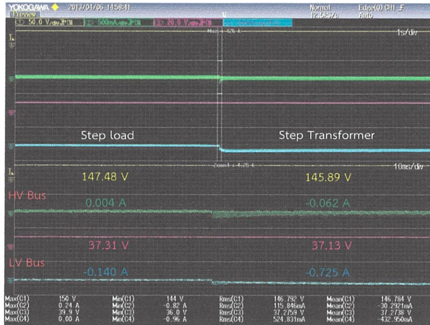
รูปที่ 6.30 แรงดันและกระแสไฟฟ้าที่ชุดวงจร M^2C^3 ที่ 2
