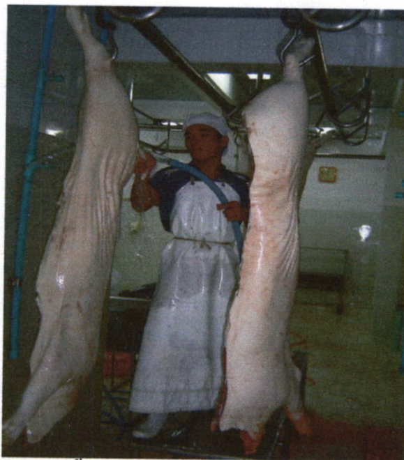
ภาพที่ 4.18 แสดงขั้นตอนการล้างซากสุกรในโรงฆ่าและชำแหละสุกร
