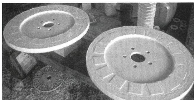
รูปที่ 2.4 การวางแท่งแม่เหล็กจำนวน 16 แท่งลงบนแผ่นจานเหล็กหมุนทั้ง 2 แผ่น
