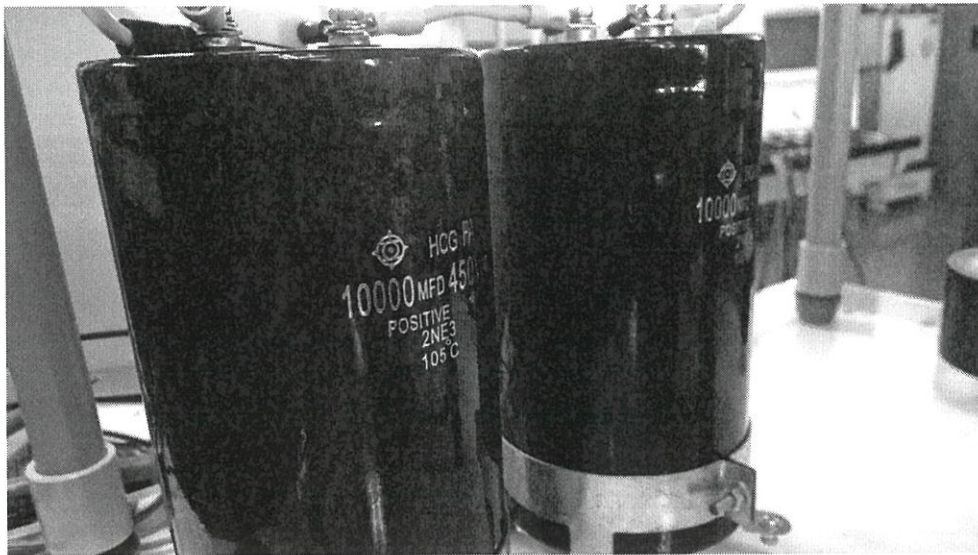
รูปที่ 6.17 ตัวเก็บประจุที่บัสไฟตรงเชื่อมโยง
