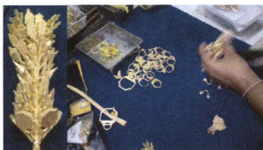
ภาพที่ 4.33 ตัดชิ้นงานจากต้นหล่อ และจัดแต่งชิ้นงาน
