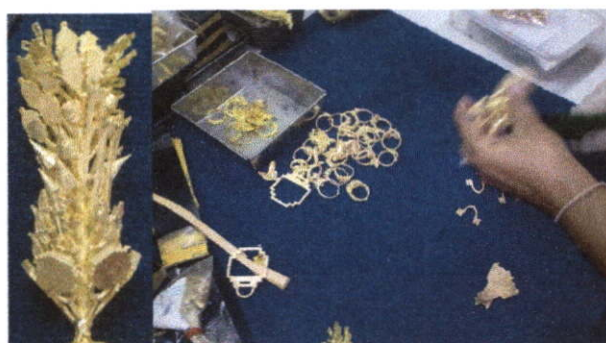
ภาพที่ 4.39 ตัดชิ้นงานจากต้นหล่อ และจัดแต่งชิ้นงาน
