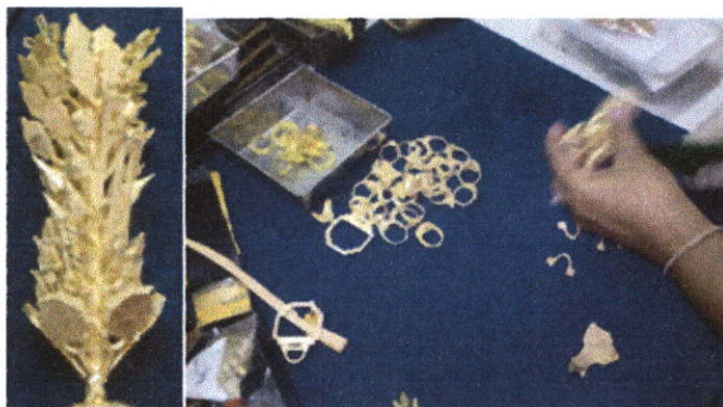
ภาพที่ 4.16 ตัดชิ้นงานจากต้นหล่อ และจัดแต่งชิ้นงาน
