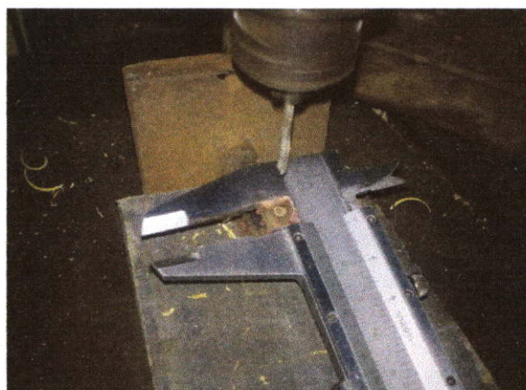
ภาพที่ 4.18 เจาะรูที่ชิ้นงาน สำหรับใส่ยางซิลิโคน
