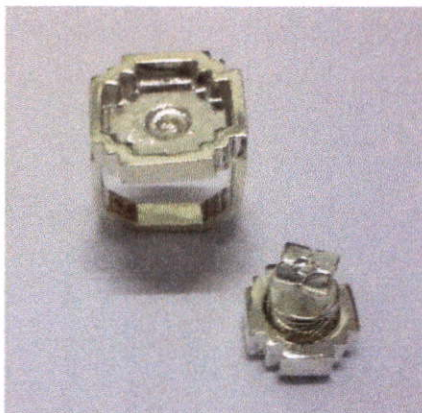
ภาพที่ 4.6 ชิ้นงานที่ผ่านการชุบเงินแล้ว
