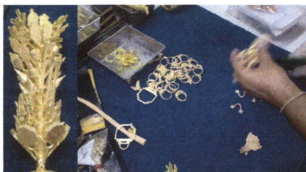
ภาพที่ 4.24 ตัดชิ้นงานจากต้นหล่อ และจัดแต่งชิ้นงาน
