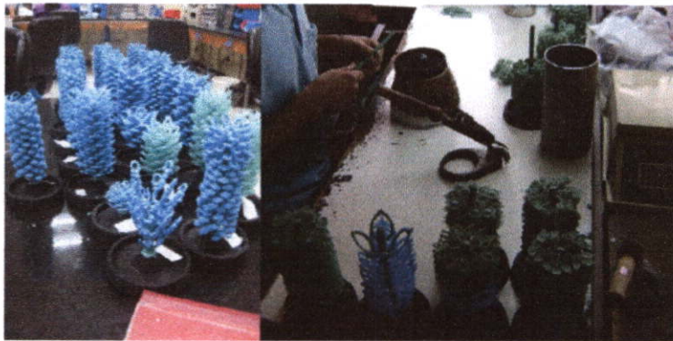
ภาพที่ 2.85 การติดต้นเทียนและชิ้นงานที่ฉีดเทียนแล้ว
