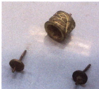
ภาพที่ 4.5 เชื่อมสลักติดกับลายประจำยาม
