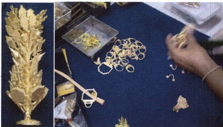
ภาพที่ 4.4 ตัดชิ้นงานจากต้นหล่อ และจัดแต่งชิ้นงาน
