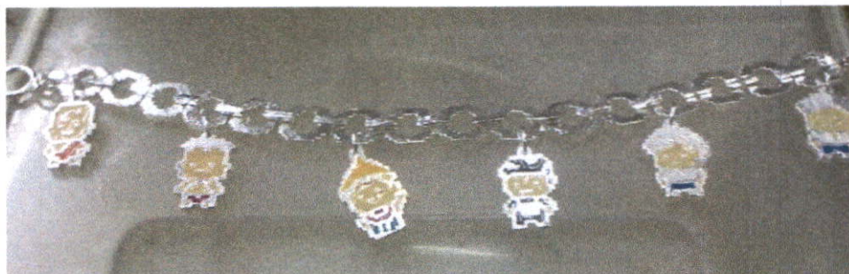
ภาพที่ 4.35 ชิ้นงานที่ผ่านการชุบเงินและลงยาสีเรียบร้อยแล้ว
