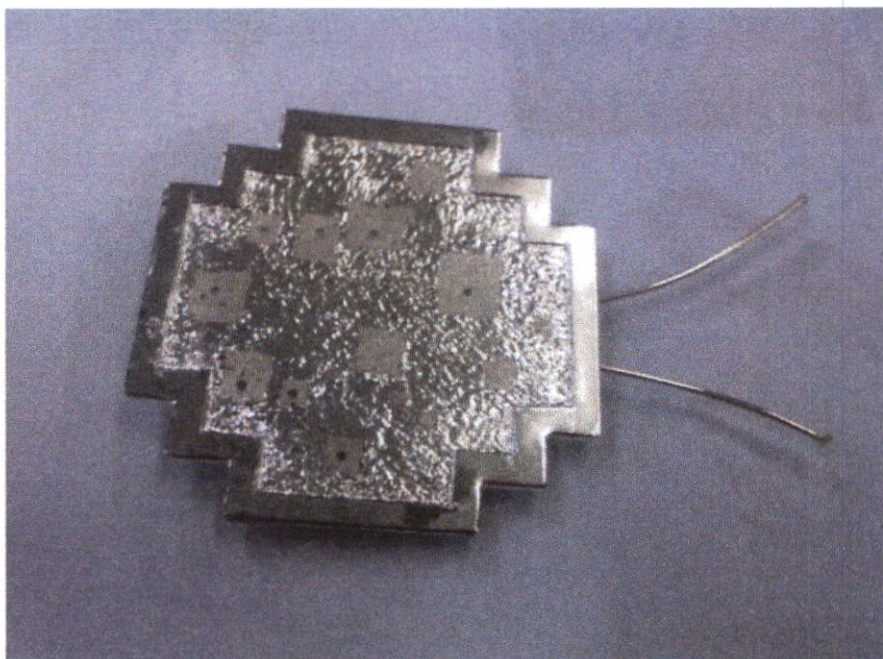
ภาพที่ 4.28 ชิ้นงานที่ผ่านการชุบเงินแล้ว
