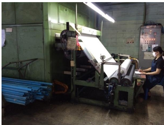
รูปที่ 4.8 ขั้นตอนการตรวจสอบผ้าของกระบวนการทอผ้าในกรณีศึกษา
