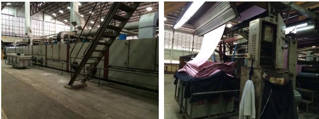
รูปที่ 4.12 ขั้นตอนการอบแห้งของกระบวนการฟอกย้อมในกรณีศึกษา
