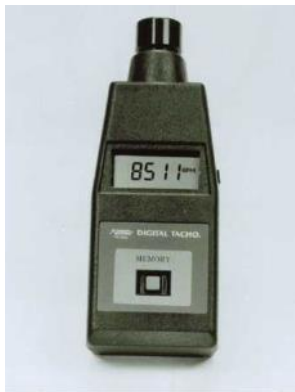
รูปที่ 3.7 เครื่องมือวัดความเร็วรอบ [31]
