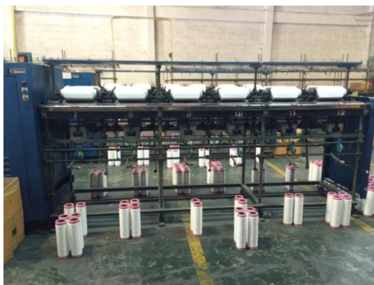
รูปที่ 4.2 ขั้นตอนการกรอถ่ายของกระบวนการทอผ้าในกรณีศึกษา
