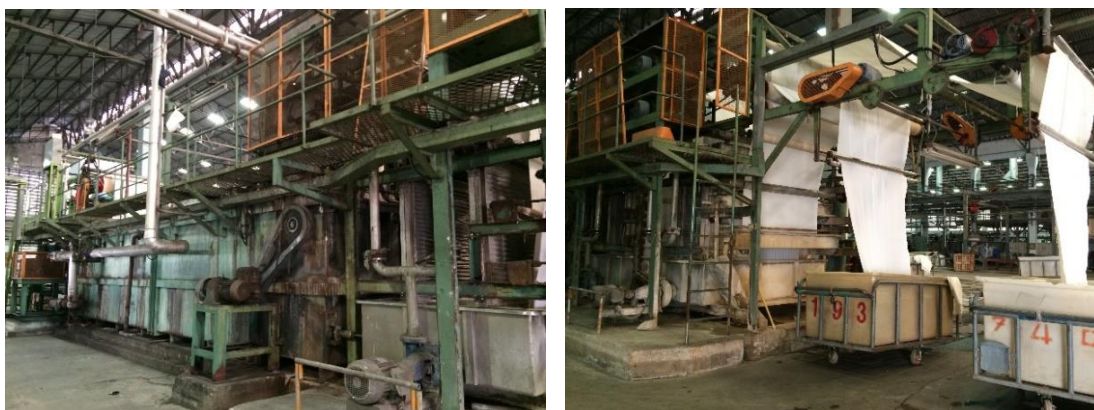
รูปที่ 4.9 ขั้นตอนการลอกแป้ง ทำความสะอาด และฟอกขาว ของกระบวนการฟอกย้อมในกรณีศึกษา
