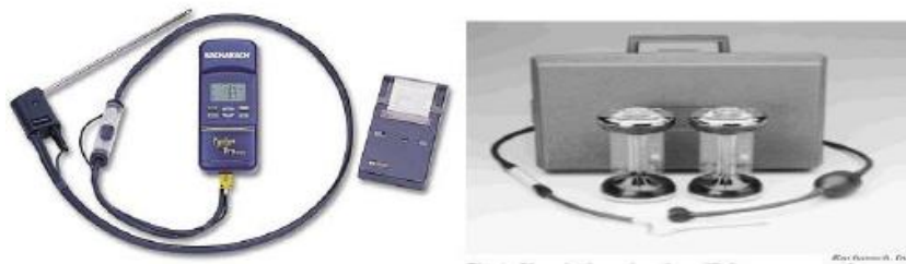
รูปที่ 3.10 เครื่องทดสอบการเผาไหม้ [31]
