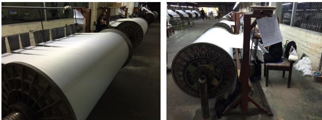
รูปที่ 4.6 ขั้นตอนการร้อยตะกอของกระบวนการทอผ้าในกรณีศึกษา
