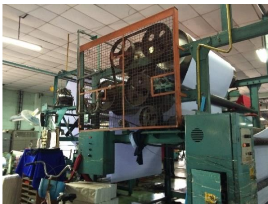
รูปที่ 4.13 ขั้นตอนการตากแต่งผ้าของกระบวนการฟอกย้อมในกรณีศึกษา
