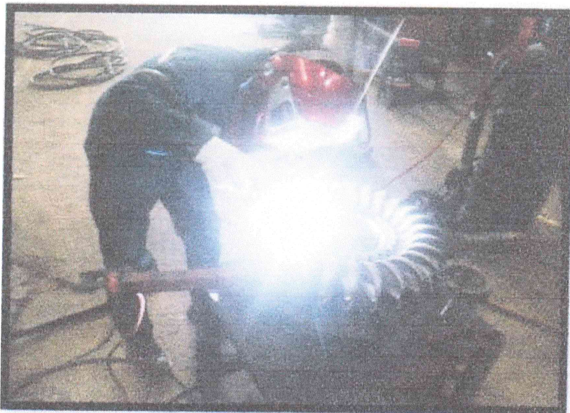
รูปที่ 4.9 การเชื่อม วงล้อใบพัดกังหันน้ำเพลตัน
