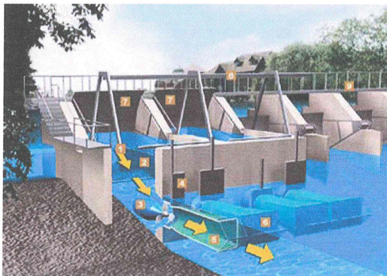
รูปที่ 2.25 แบบจำลองการตัดแปลงสำหรับติดตั้งเครื่องกังหันน้ำบริเวณประตูระบายน้ำ [12]
