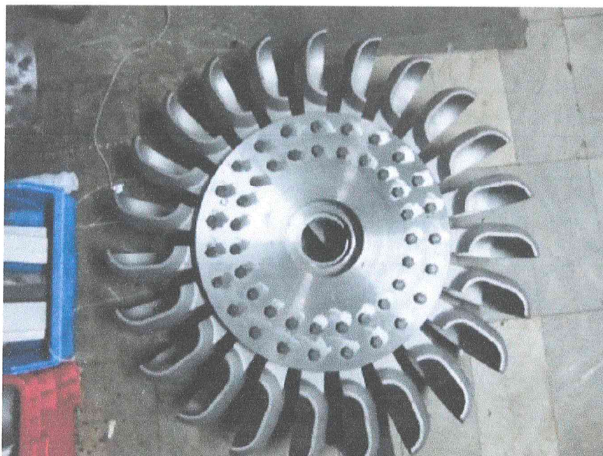
รูปที่ 2.22 ใบพัดกังหันน้ำเทอร์โก้ (Turgo turbine) ที่เรียงประกบกัน[11]
