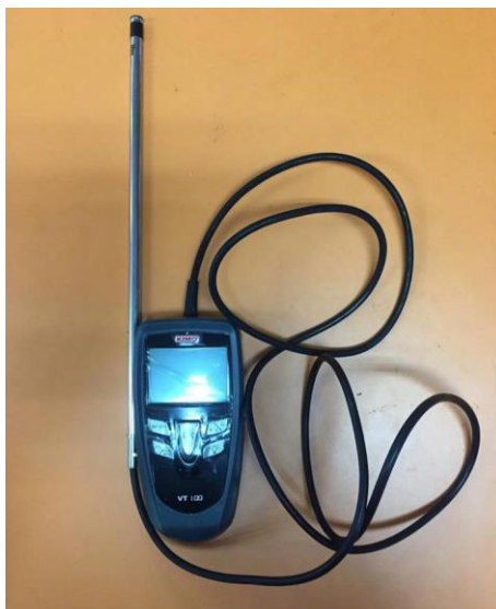
ภาพที่ 3.8 Hotwire thermo-anemometer Kimo VT100 (ที่มา : ผู้วิจัย)
