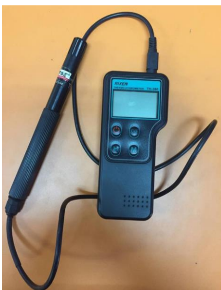
ภาพที่ 3.9 Thermo Hygrometer Rixen series no RXN 380189E (ที่มา : ผู้วิจัย)
