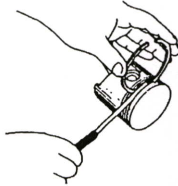
รูปที่ ข.45 การตรวจเช็คช่องว่างระหว่างแหวนลูกสูบกับร่องแหวน
