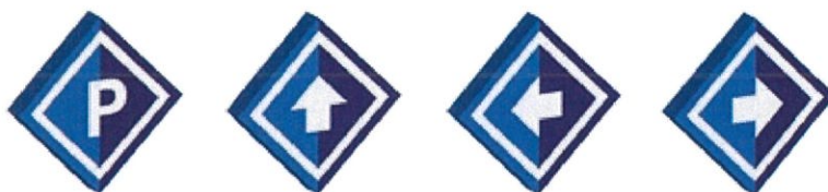
ภาพที่ 6.29 ป้ายเครื่องหมายจราจร (ขนาด 0.6 x 0.6 m.)
