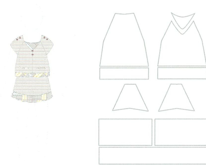
ภาพที่ 4.7 แสดงการวางแบบตัดของชุดลำลอง (เสื้อและกระโปรง)
