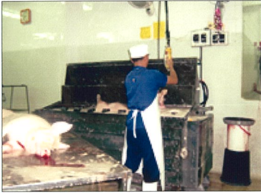
การลอกซากในเครื่องลอกซากและชูดขน
