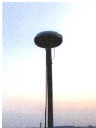
รูปที่ 3.6 สายอากาศรับสัญญาณดาวเทียม GPS (NovAtel's Model 502GPSAntenna)
