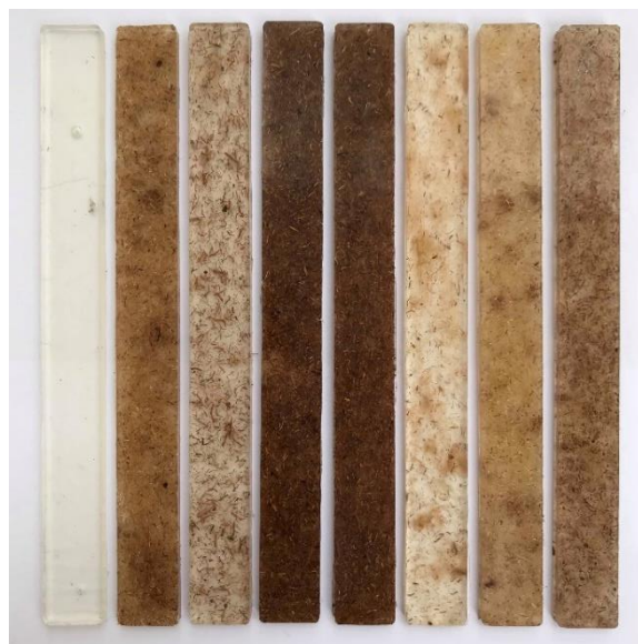
รูปที่ 3.14 (a) ขนาดของชิ้นงาน Izod Type ในการทดสอบตามมาตรฐาน ASTM D256 (b) ชิ้นงานทดสอบ PLA และชิ้นงานทดสอบตามอัตราส่วนจากการออกแบบการทดสอบ RUN1-RUN7 ตามลำดับ
