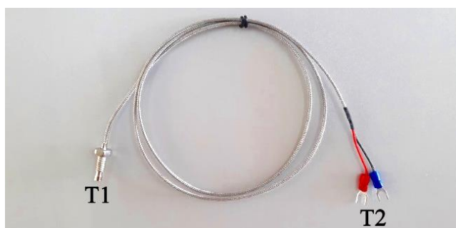
ภาพที่ 5.6 เทอร์โมคัปเปิลที่ใช้ในการทดลอง
