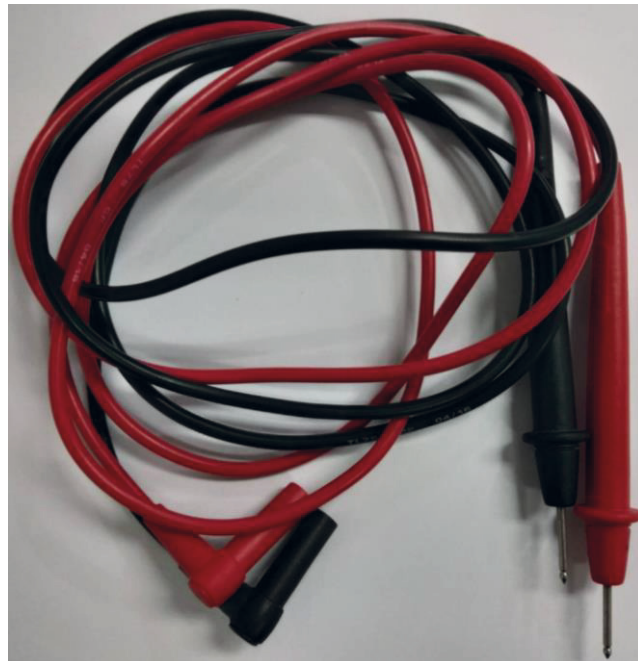
ภาพที่ ง.6 ชุดสายวัดมัลติมิเตอร์
