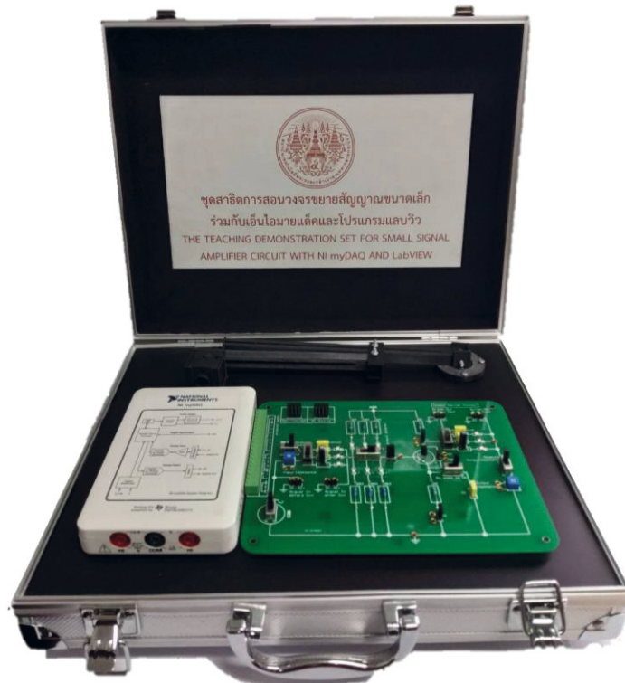
ภาพที่ ง.1 ชุดสาธิตการสอนวงจรขยายสัญญาณขนาดเล็กร่วมกับเอ็นไอมายเด็คและโปรแกรมแลบวิว
