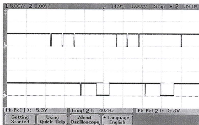
รูปที่ 4.26 สัญญาณรบกวนของภาคสวิทซ์ซึ่งในเครื่องคอมพิวเตอร์ทำให้ข้อมูลเกิดความผิดพลาด
