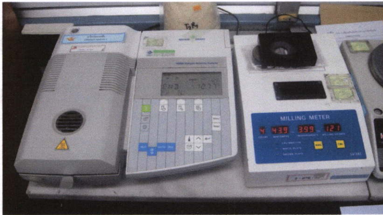
ภาพที่ 1ก การวิเคราะห์ความชื้นด้วยเครื่องวัดความชื้น (moisture analyzer) รุ่น MG53
