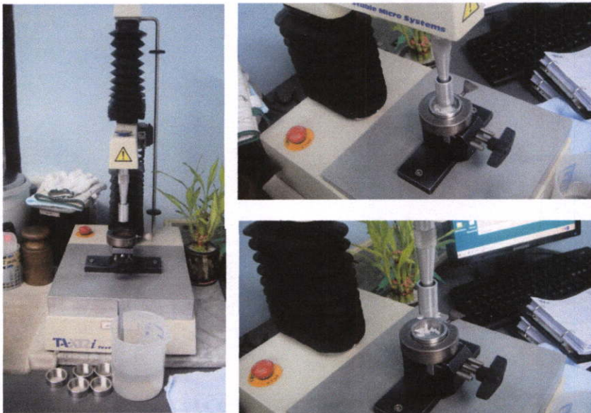
ภาพที่ 2ง การวิเคราะห์ความแข็งด้วยเครื่องวัดความแข็ง (texture analyzer) รุ่น xT2i
