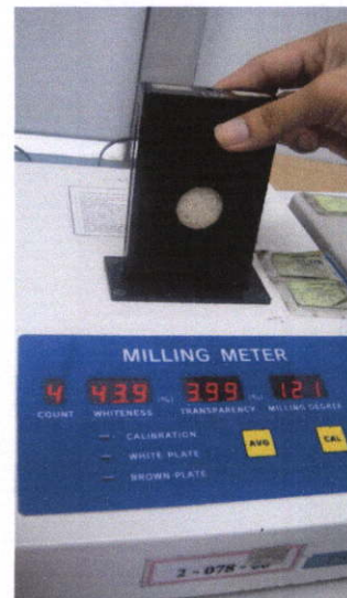
ภาพที่ 1ข การวิเคราะห์ความขาวด้วยเครื่องวัดความขาว (whiteness tester) รุ่น MM1B
