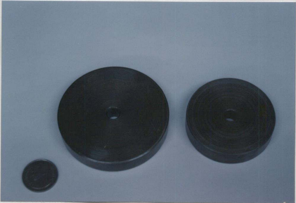
รูปที่ 5.3 ลักษณะของอินอร์เชียโหลด (Inertia load) ที่ใช้ในการทดลอง ด้านซ้ายคืออินอร์เชียโหลดขนาด 400 กรัม และด้านขวาคือโหลดขนาด 200 กรัม
