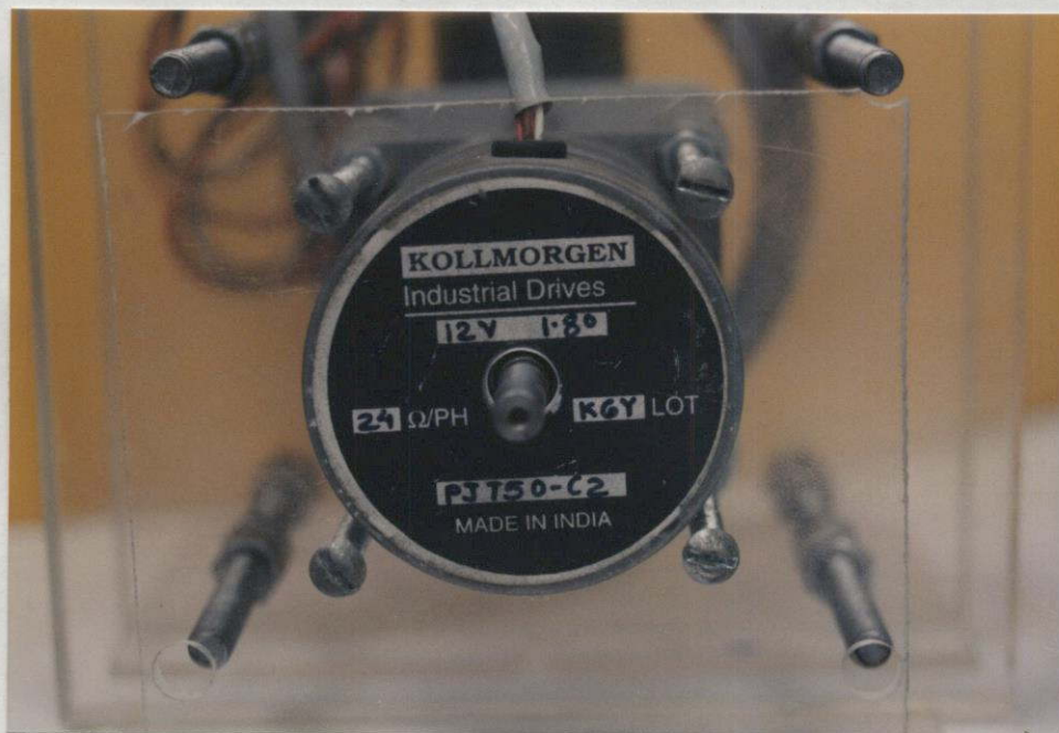
รูปที่ 5.1 แสดงลักษณะของสเตปปีงมอเตอร์ที่ใช้ในการทดลอง
