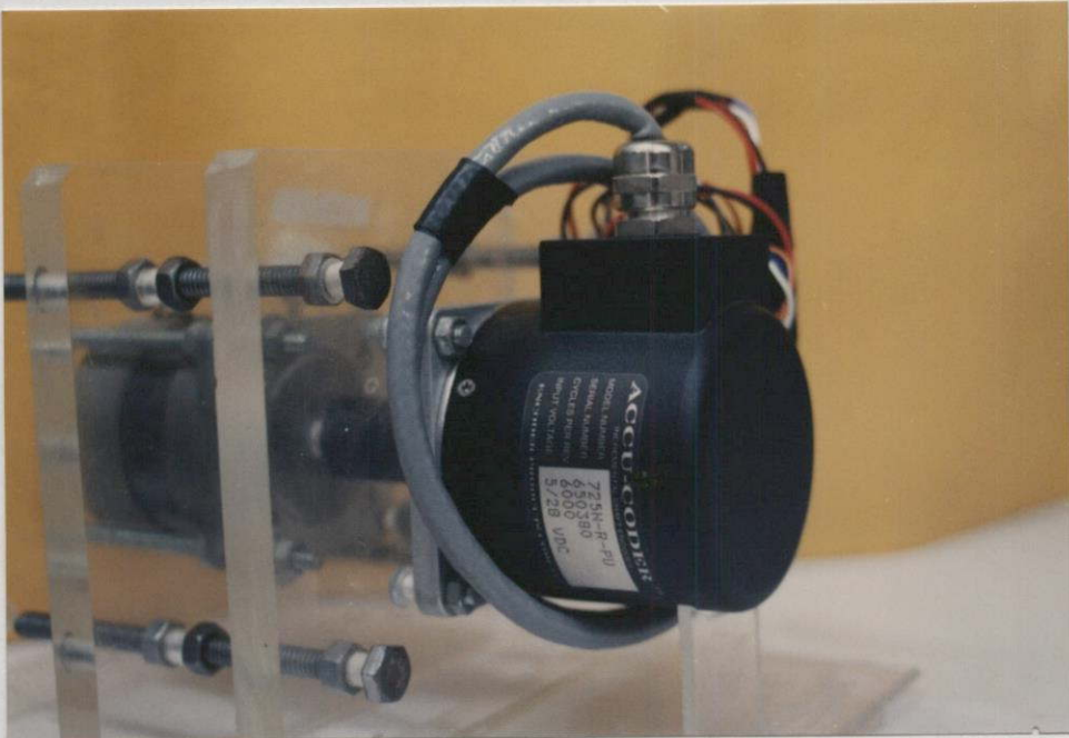
รูปที่ 5.2 ลักษณะของออฟติคอลลีนโคคเตอร์ที่ใช้ในการทดลอง
