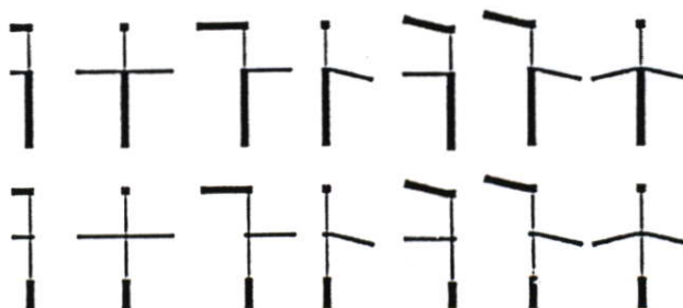
รูปที่ 1.6 แสดงรูปแบบทั่วไปของ Light Shelve ที่มีการใช้งานจริง
