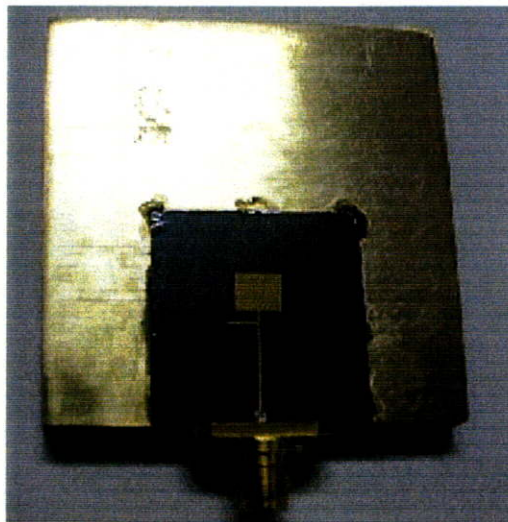
รูปที่ 6.2 สายอากาศแผ่นแบบโมโนลิทริกบนวัสดุฐานรองซิลิคอนโคปทองคำ
