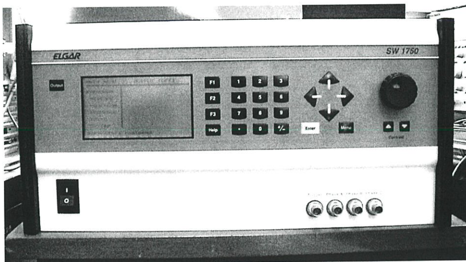
รูปที่ 5.11 แหล่งจ่ายไฟฟ้ากระแสตรงแบบจ่ายแรงดันคงที่ที่ใช้ในการทดสอบ
