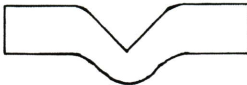
รูปที่ 3.3 ชิ้นงานทดสอบความแข็งแรงฉีกขาด Die C ตามมาตรฐาน ASTM D 624
