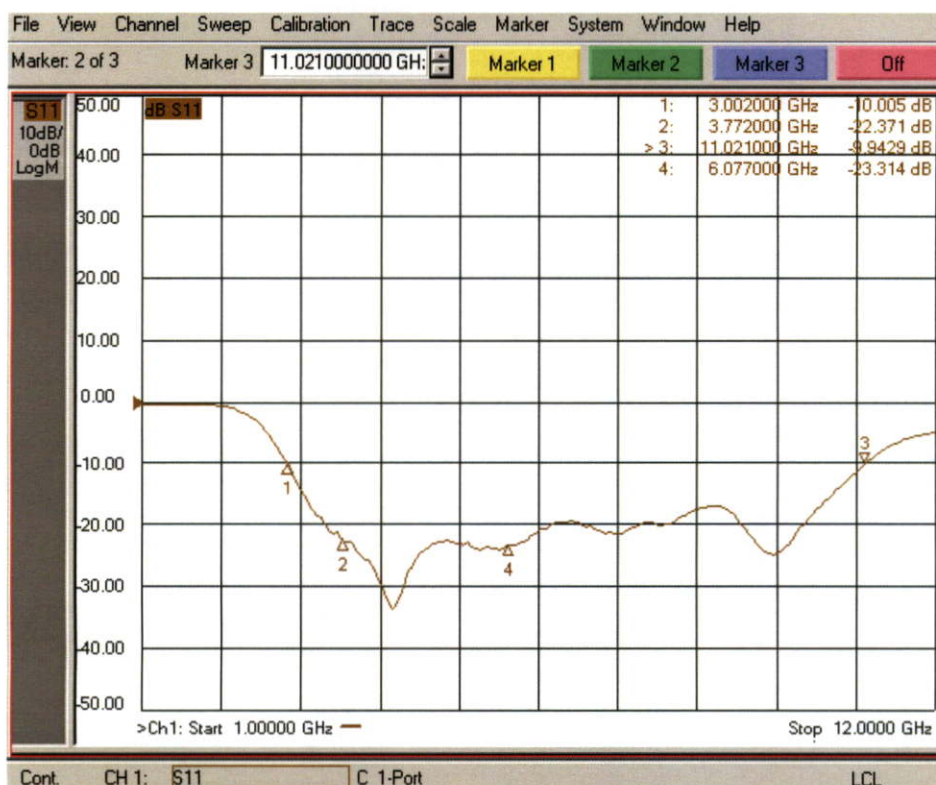
รูปที่ ก.1 ผลการวัดการสูญเสียย้อนกลับ ( S_{11} ) ของสายอากาศช่องเปิดที่มีตัวปรับแบบสายท่อนสั้น (Tuning stub) วงแหวนสี่เหลี่ยมผืนผ้า
