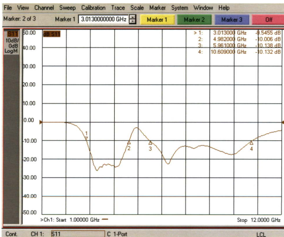
รูปที่ ก.2 ผลการวัดการสูญเสียย้อนกลับ ( S_{11} ) ของสายอากาศช่องเปิดที่มีแบนด์นอตช์เดี่ยวโดยใช้พาราซิติกอิมเมนต์รูปตัวแอล (L-shaped)
