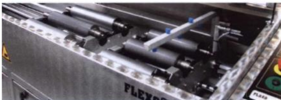
รูปที่ 2.5 การใช้เครื่องทำความสะอาดระบบอัตโนมัติ
