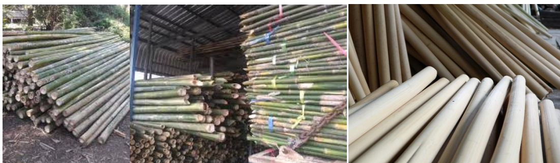
ภาพที่ 4.2 แสดงไม้ไผ่หนวลก่อนและหลังการเตรียมวัสดุ
