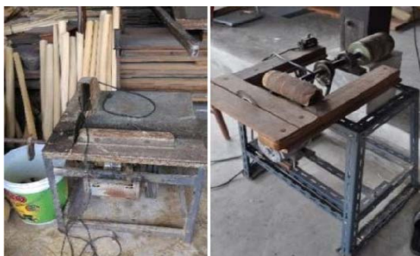
ภาพที่ 4.5 เครื่องตัดและเครื่องขัดกระดาษทรายที่นำเข้ามาใช้ทุ่นแรง
