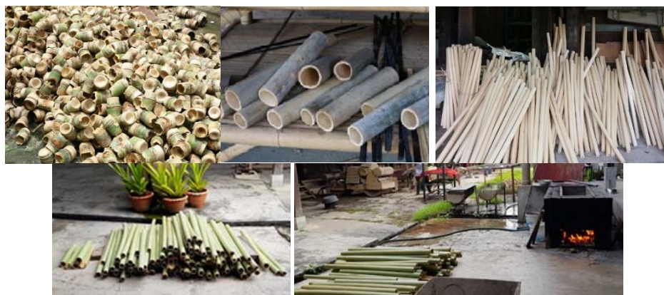
ภาพที่ 4.6 แสดงการตัดข้อไม้ แบ่งช่วงไม้ ขูดผิวชั้นนอกออกจนเห็นผิวชั้นใน และนำไปต้ม
