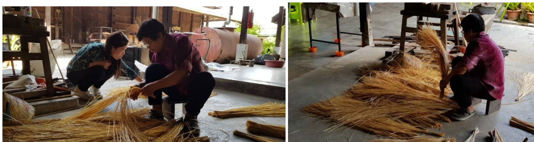
ภาพที่ 4.8 แสดงการเตรียมขีดแยกขนาด และเตรียมตอกเพื่อนำไปย้อม
