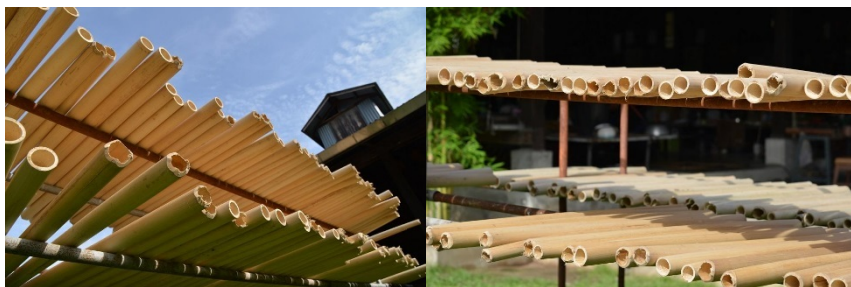
ภาพที่ 4.7 แสดงการตากไม้ไผ่จนแห้งหลังจากการนำไปต้ม
