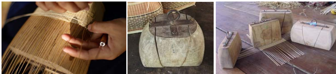
ภาพที่ 4.11 แสดงการขึ้นรูปแบบมีต้นแบบ และแม่แบบหุ่นสานรูปทรงต่างๆ
