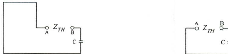
(c) วงจรแสดงการหาอิมพีแดนซ์เทียบเท่าเรวินินที่จังหวะต่างๆ ของวงจรอินเวอร์เตอร์
