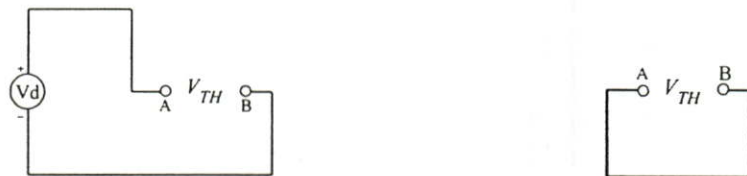
(d) วงจรแสดงการหาแรงดันเทียบเท่าเรวินินที่จังหวะต่างๆ ของวงจรอินเวอร์เตอร์
