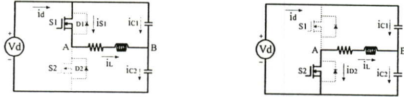
(b) วงจรแสดงการทำงานในจังหวะต่างๆ ในช่วง 1 ไซเคิล ของวงจรอินเวอร์เตอร์
