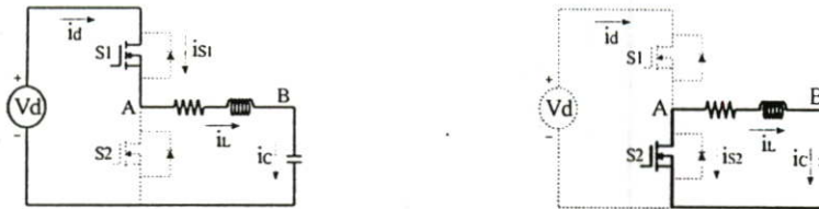
(b) วงจรแสดงการทำงานในจังหวะต่างๆ ในช่วง 1 ไซเคิล ของวงจรอินเวอร์เตอร์
