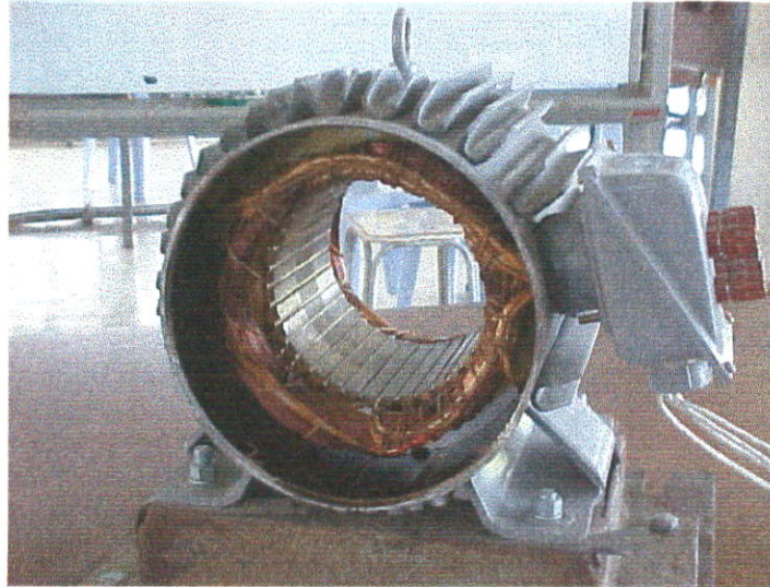
รูปที่ 2.2 ส่วนที่อยู่กับที่ (Stator) ของมอเตอร์ไฟฟ้าเหนี่ยวนำ
