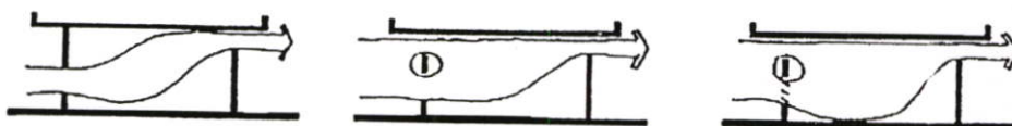
ภาพที่ 2.4 การใช้ชายคาระดับช่องเปิด และใช้อุปกรณ์ประกอบช่องเปิดเข้า จะทำให้เกิดการระบายอากาศได้มากขึ้น
