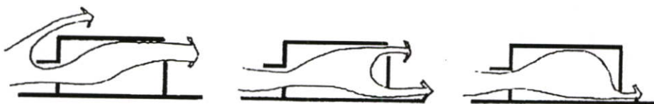
ภาพที่ 2.3 ช่องเปิดทางออกของอากาศวางในตำแหน่งที่ต่างกัน แนวการไหลของอากาศจะแตกต่างกัน
