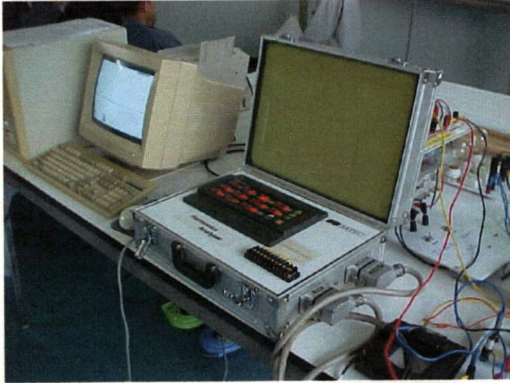
รูปที่ ก-1 เครื่องมือวัด Harmonic Spectrum
