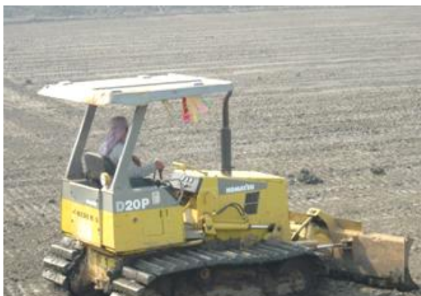
ภาพที่ 2.5 การปรับสภาพพื้นบ่อก่อนการเลี้ยงโดยใช้รถปรับ
