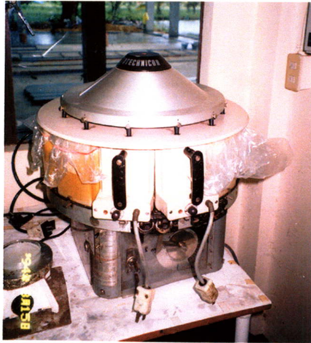
รูปที่ 1 เครื่องเตรียมเนื้อเยื่ออัตโนมัติ (automatic tissue processor)
