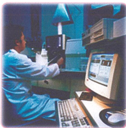
รูปที่ 1.4 เครื่อง CV-AAS สำหรับตรวจวัดปริมาณปรอท (ที่มา: http://www.chemlab.com.my/labtesting.asp )
