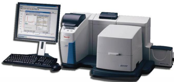
ภาพที่ 3.6 เครื่องรามานสเปกโตรมิเตอร์ (Raman spectrometer) รุ่น DXR Smart Raman
