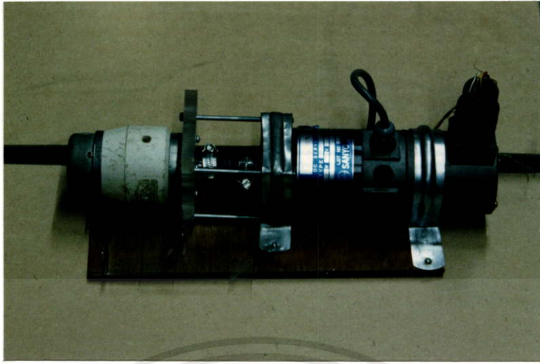
ภาพที่ 5.4 แสดงดีซีมอเตอร์และโหลดที่ต่อตัวคู่ความเร็วเข้าด้วยกัน
