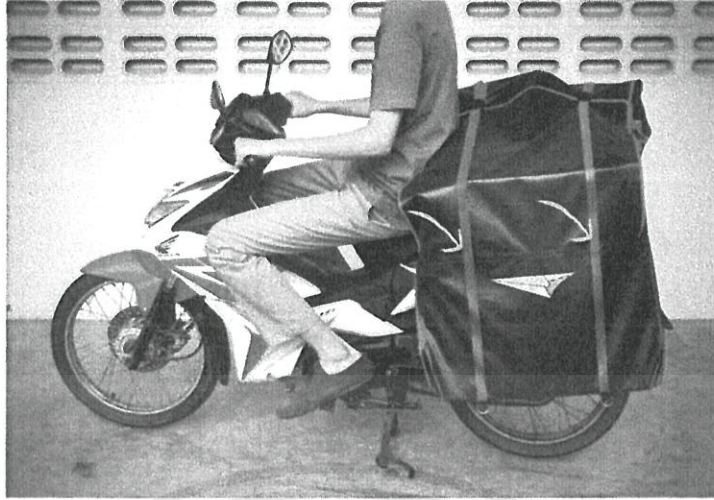
ภาพที่ 5.11 ภาพอุปกรณ์นำจ่ายที่ปรับปรุงต่อสายผ้าแล้ว
