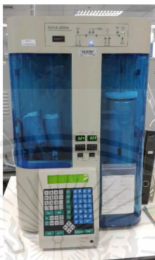
รูปที่ 3.10 เครื่องวิเคราะห์พื้นที่ผิวและรูพรุน (Surface area & Pore size analyzer) รุ่น NOVA 2000e
