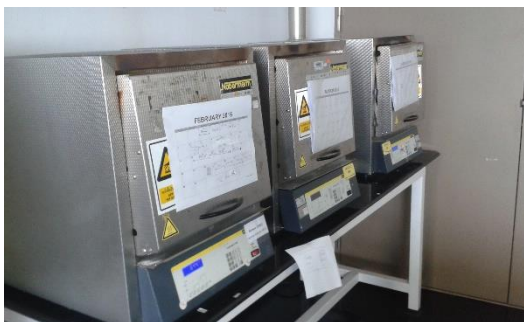
รูปที่ 3.4 เตาเผาความร้อนสูง (Muffle Furnace) ยี่ห้อ Nabertherm สำหรับกระบวนการเผาตัวเร่งปฏิกิริยา
