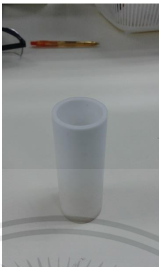
รูปที่ 3.14 ครอบกึ่งเฟลลอนสำหรับบรรจุสารสำหรับทำปฏิกิริยาในกระบวนการเร่งปฏิกิริยา
