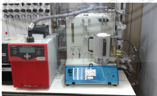
รูปที่ 3.12 เครื่องวิเคราะห์สมบัติทางเคมีตามการเปลี่ยนแปลงอุณหภูมิ (TPR/TPD Chemisorption Analyzer) รุ่น Quantachrome INSTRUMENTS ChemBET Pulsar
