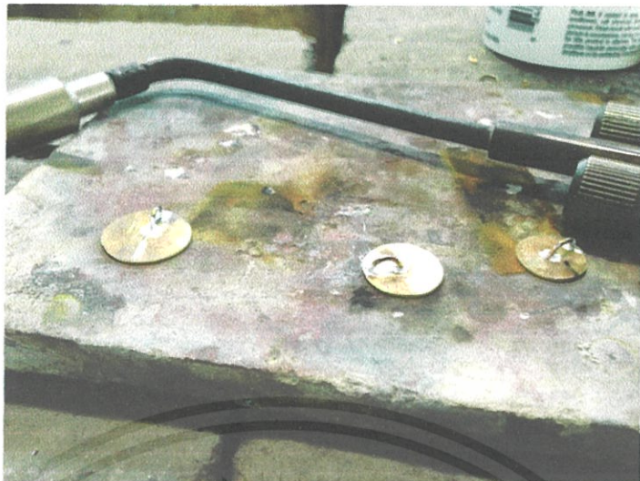
รูปที่ 153 กัดกรดและฉลุล้วนนำมาเชื่อมห้วงส่วนประกอบสร้อยคอ
