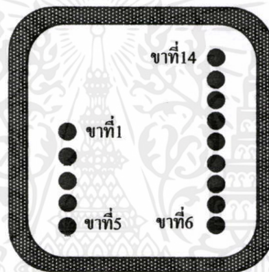
ภาพที่ 2.7 ตำแหน่งขาของ โมดูล RFID รุ่น ID20-MF
