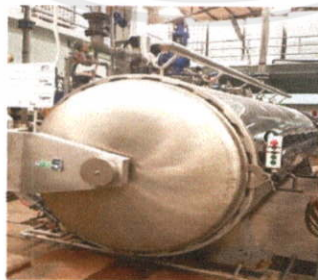
รูปที่ 3.10 หม้อฆ่าเชื้อแบบ Still steam retort
