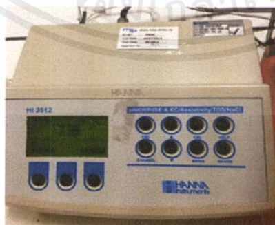
รูปที่ 3.5 เครื่องวัด pH ยี่ห้อ HANNA รุ่น HI3512
