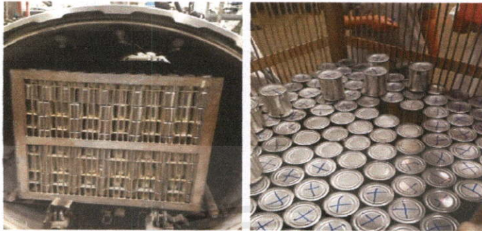
รูปที่ 3.11 การจัดเรียงน้ำกะทิกระป๋องลงในตะกร้าก่อนเข้าหม้อฆ่าเชื้อ
