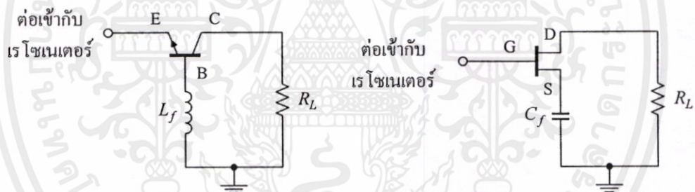
รูปที่ 4.4 วงจรออสซิลเลเตอร์ (ก) วงจรคอมมอนเบส (ข) วงจรคอมมอนซอร์ส
